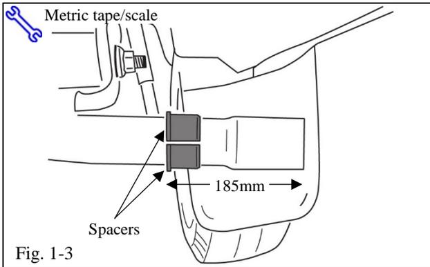
(d) Place the spacers on the exhaust pipe 185mm from the tip (Fig. 1-3).
